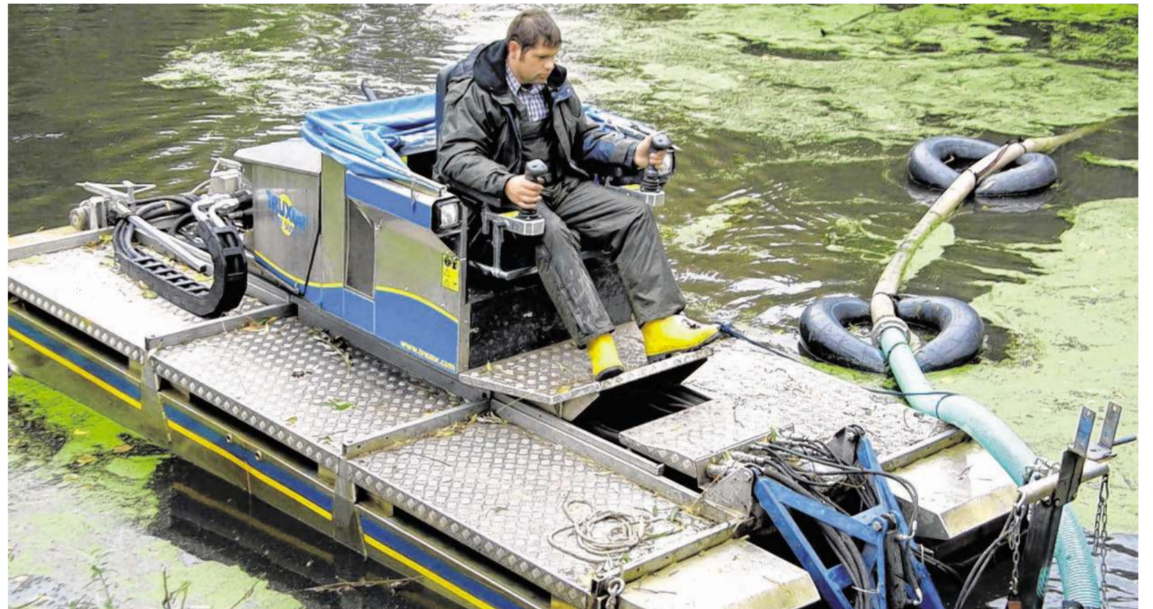
Der Truxor in Aktion: Innerhalb einer Woche befreite der sanfte Stahlkoloss den Ruraltarm der Karkener Angelfreunde vom unnötigen Schlamm.
